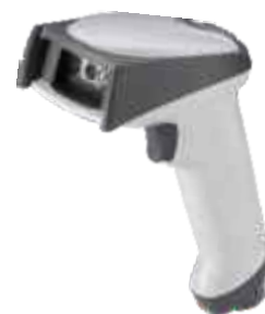
Leitor Handheld 4600g leitor pistola de código de barras laser Imager (2D) Peso: 1,640kg
